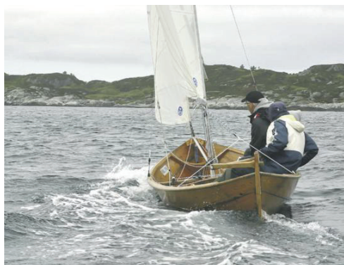
KLINKBYGD TREBÅT: Oselvar er ein klinkbygd trebåt frå Hordaland som mellom anna er brukt som regattabåt.
